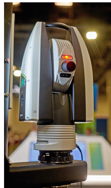
Laser tracker Leica AT500 equipaggiato con il tastatore wireless B-Probeplus
